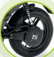
Motore con ingranaggi elicoidali
